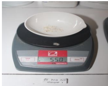
Gambar 2. Pengujian Kadar Abu Karaginan Rumput Laut E. cottonii .
